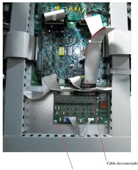
Tarjeta de control de la conexión en paralelo
