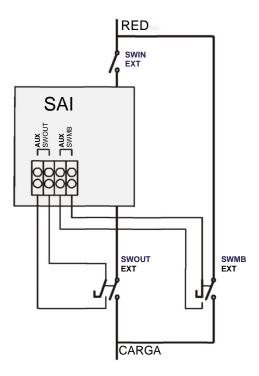
Interruptor de desconexión de salida adicional SWOUT EXT, interruptor de desconexión de derivación adicional SWBY EXT de la derivación de mantenimiento externo.
