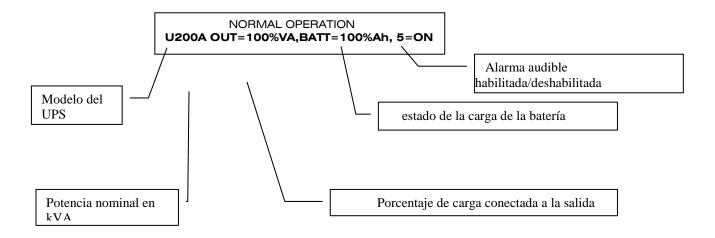
El mensaje U200A indica un modelo de UPS con una potencia nominal de 200 kVA, funcionando con una frecuencia de salida de 60 Hz.
