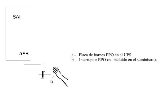
En el UPS, se debe quitar el puente en los bornes EPO, y los conductores del contacto auxiliar del botón deben conectarse en lugar del puente.
