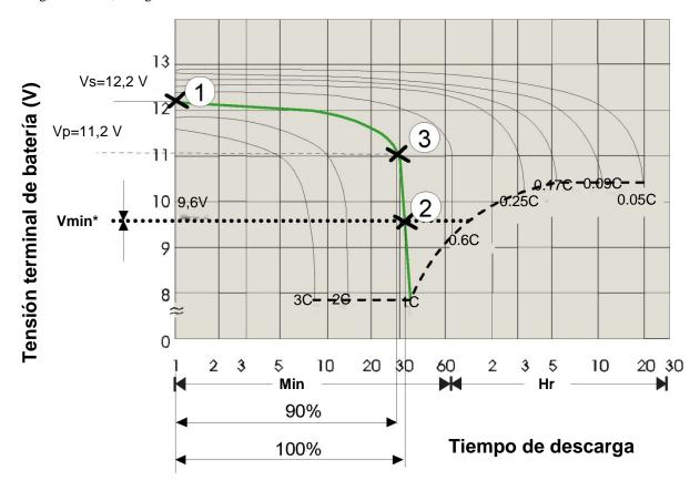
Los tres valores, Vs, Vmin y Vp, se obtienen a partir de la curva típica de la descarga, suministrada por el fabricante, en relación con el *régimen de descarga de la batería* 1C se ha determinado:
