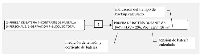
Activa el ciclo para revisar el estado de eficiencia de la batería, que dura 8 segundos. Pulse la tecla 8 para interrumpir la prueba y regresar al menú básico antes de que este tiempo haya transcurrido.
