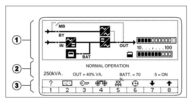
La pantalla se divide en cuatro áreas principales; cada una de ellas con una función específica.
