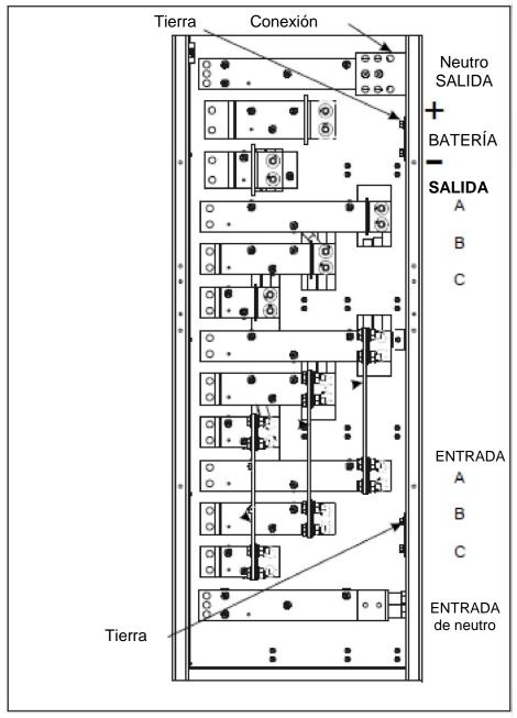
Nota: Para las conexiones de entrada, salida y batería, respete el orden de arriba a abajo, o de derecha a izquierda, tal y como se describe en las cajas. La "N" marcada en los bornes representa el borne de neutro.
