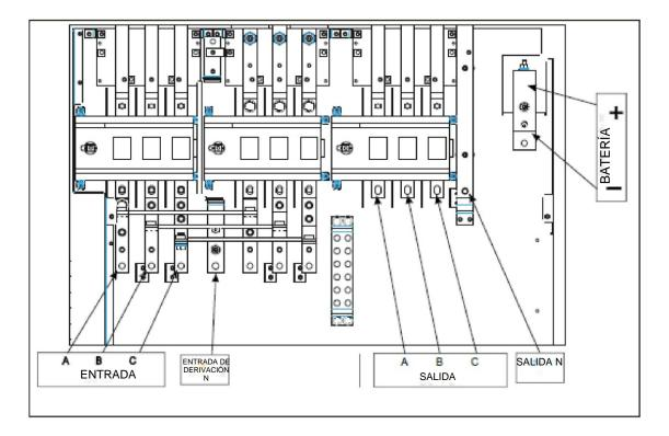
Nota: Para las conexiones de entrada, salida y batería, respete el orden de arriba a abajo, o de derecha a izquierda, tal y como se describe en las cajas. La "N" marcada en los bornes representa el borne de neutro.
