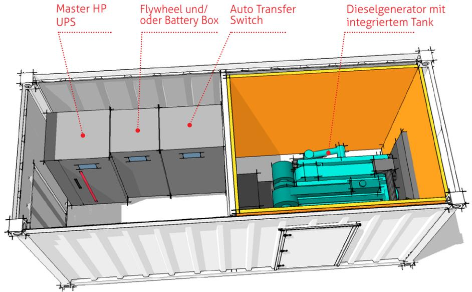
PowerBox ist in unterschiedlichen Kombinationen verfügbar. Im Folgenden sind zwei Beispiele für Container-Installationen zu 20 und 40 Fuß aufgeführt, die UPS Riello, ein Schwungrad und einen Dieselgenerator beinhalten.
